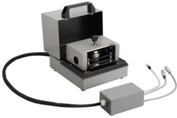
这款 N1424A/B/C 电阻率电极可与 B2985/87B 配合使用，以测量绝缘材料的表面或体积电阻率。三种电极（直径：26 mm/50 mm/76 mm），可满足 ASTM D-257 等各种绝缘测量标准。
