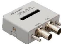
该适配器用于将仪器 GPIO Dsub25 连接器的触发信号路由至两个同轴连接器。它适用于 B2901/10BL、B2901/02/11/12B 和 B2961/62B。此外，您可以将导线焊接到适配器内部印刷电路板上的相应数字 I/O 路径来访问任何数字 I/O 信号引脚。
