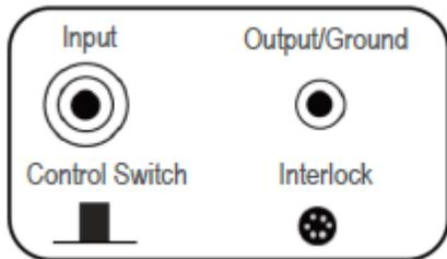
输入：三轴（特殊螺丝型）输出/接地\*：高压 BNC（特殊型）联锁：6 针迷你插头互锁连接器
