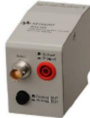
该适配器简化了使用 B2985/87B 进行电阻测量时的布线。此外，通过使用此适配器，源电压可以通过 B2985/87B 中的电压表监控，而无需更改连接。
