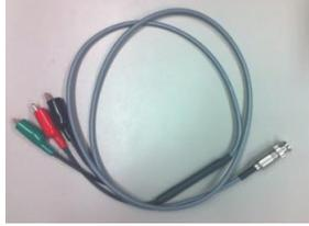
三同轴电缆的一端带有一个公头三同轴连接器，另一端带有三个鳄鱼夹。它支持高达 200 V 和 1A DC。它与 B2901/10BL、B2901/02/11/12B、B2961/62B 和 B2981/83/85/87B 兼容。
