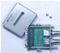
**N1294A-032 用于多单元控制的数字 I/O 触发电缆**
