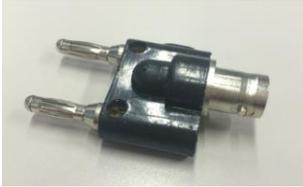
双香蕉转 BNC 适配器，用于连接带有双香蕉插孔的仪器
