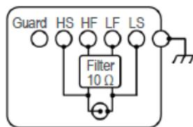
**用于 B2961/62B 的 N1298B 超低噪声滤波器 (42V/105mA, 50 Ω) :**
