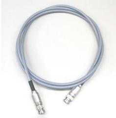
16494A 三轴电缆适用于低至 sub-fA 级的低电流应用。它支持最大电压/电流 200V/1A DC。
