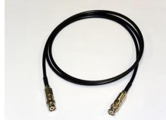
N1412A/B/C 三轴电缆适用于低至 sub-fA 级的低电流应用。该电缆支持的最大电压/电流为 500 V/1 A DC。
