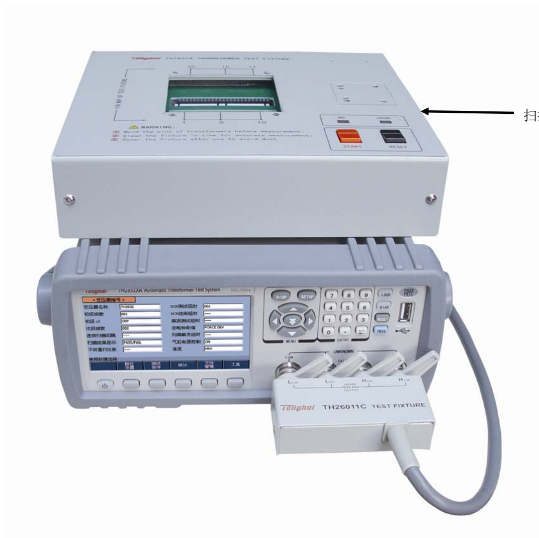
Pic702: 扫描盒测试电缆的连接
