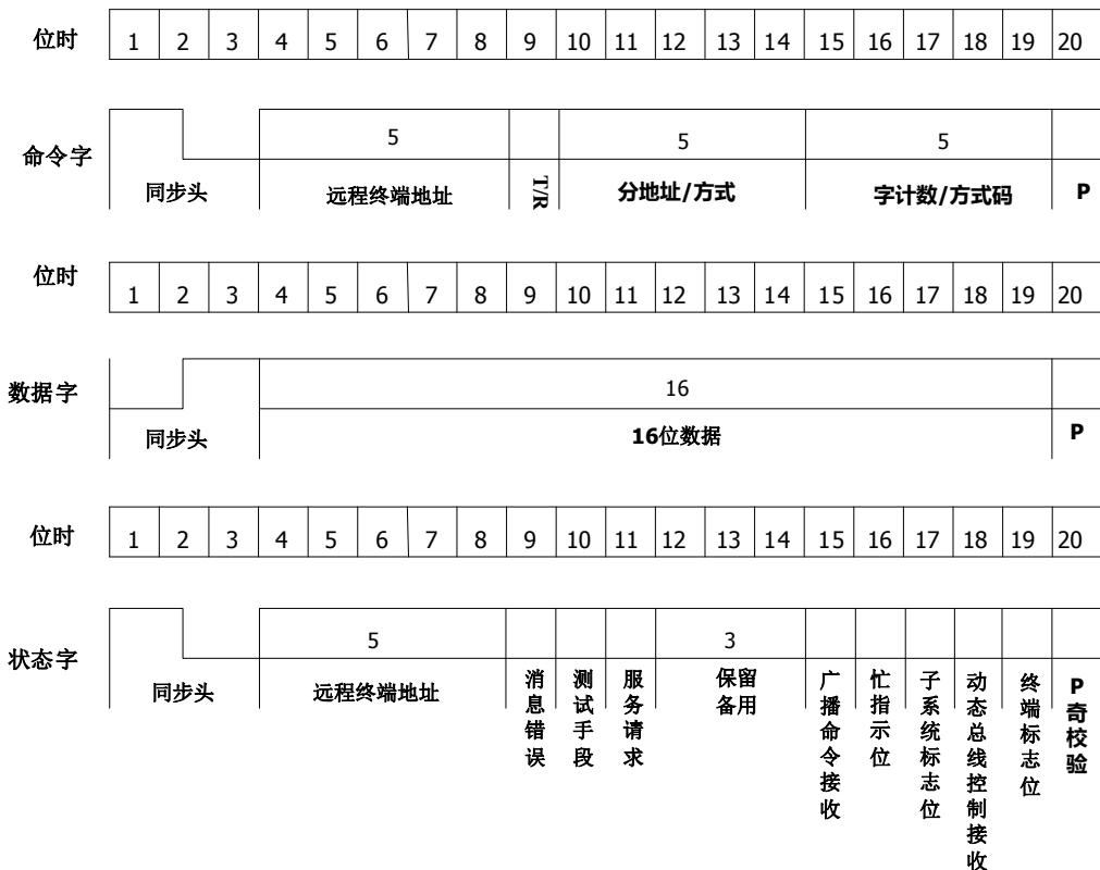
图 5-23 1553B 总线命令字、数据字和状态字格式图
