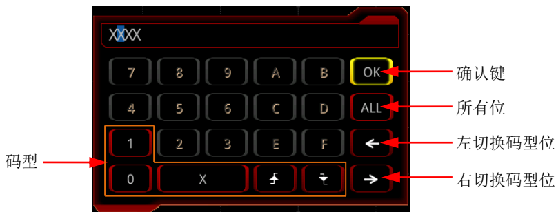
图 5-6 码型设置虚拟键盘
