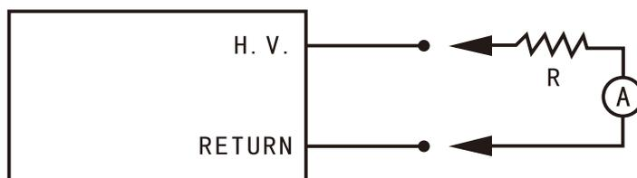
注明：请将电流表接在靠“RETURN”的端子，以避免电流的读值不准确和电流表意外受损。
