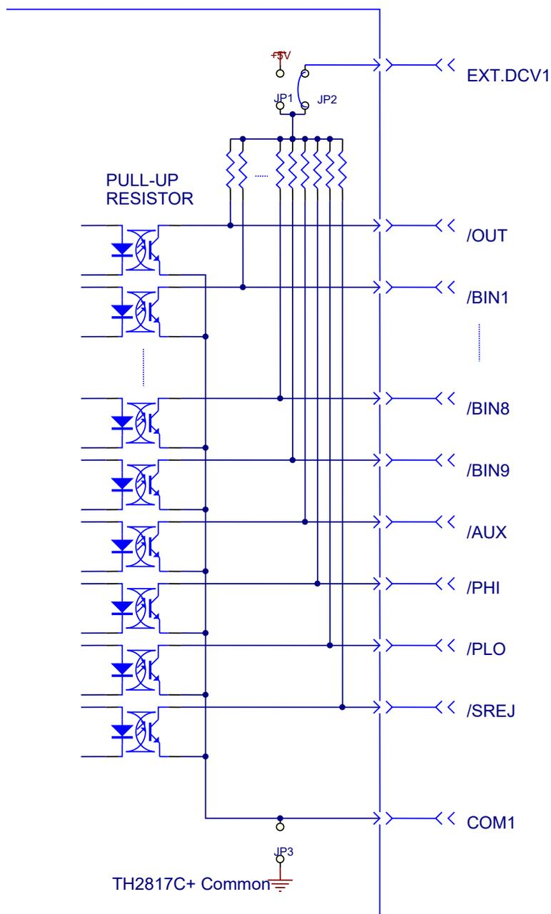
控制信号输出电路
