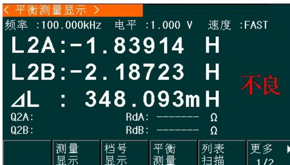
在该页面上，测试结果将以大字符显示。下列测量控制参数可在本页面设定。
