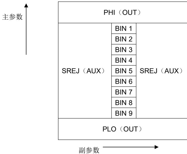
图 1 档比较功能/PHI, /PLO, /SREJ 信号的分配区域示例
