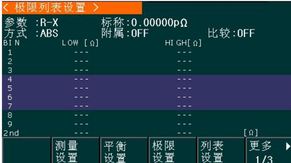
在该页面可以对仪器比较器功能进行设置。TH2817C+可设定 9 个主参数的档极限以及一个副参数的档极限值。被测结果可分选成最多 10 个档（BIN1 至 BIN9 和 BIN OUT）。如果被测件的主参数在 BIN1 至 BIN9 的极限范围内，但是其副参数不在极限范围内，这时被测件被分选到附属档中。当 TH2817C+ 安装了 HANDLER 接口，并运用在自动测试分选系统时，比较功能特别有用。下列比较功能的极限参数只能在<极限列表设置>页面进行设定。
