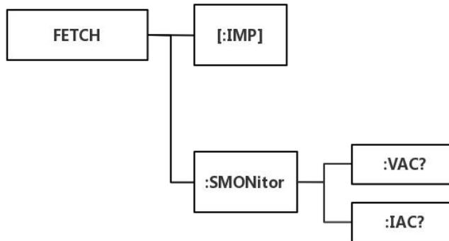
`[:IMP]?` 命令使 TH2817C+ 把最后一次测量的结果送到 TH2817C+ 的输出缓冲区。
