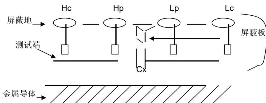
图 5-2 消除杂散电容影响方法示意图
