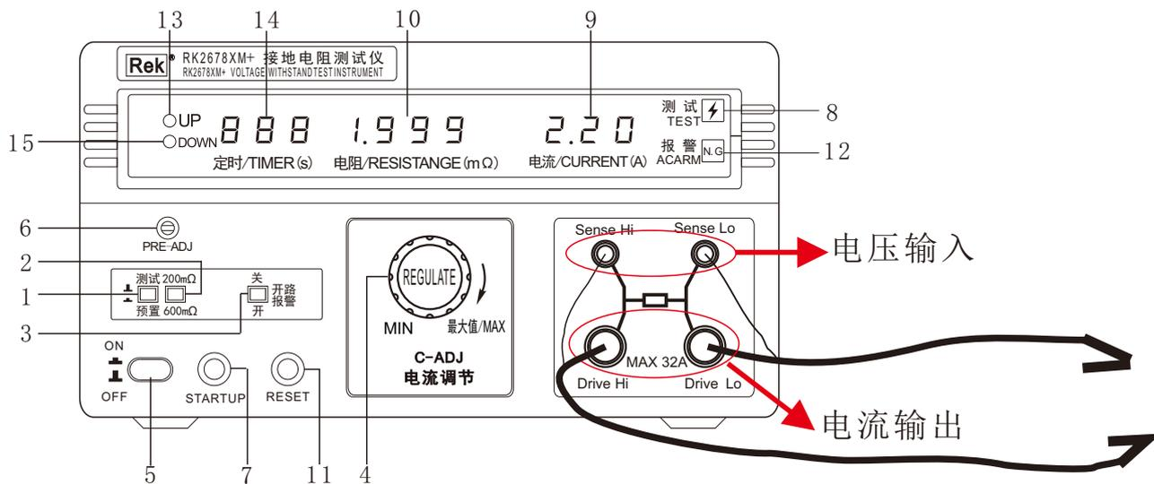
一、接通电源前，先将仪器面板：测试/预置 1，200mΩ/600mΩ 2，开路报警 3，三个按键弹出，“电流”调节旋钮 4 逆时针调至0点。
