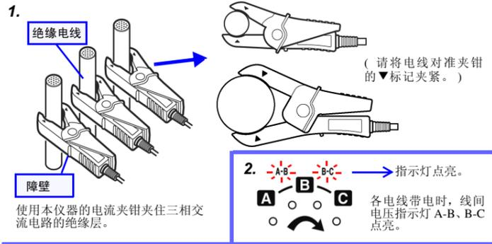
3. 相序指示灯沿着箭头方向（顺时针）进行依次闪烁时，表明其连接相序为正相 (A-B-C)。此时，蜂鸣器会发出断续音。
