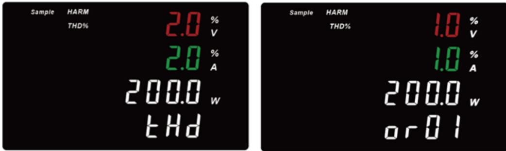
按” THD/%”，选“THD”模式进入电压电流总谐波绝对值测量。按“▲，▼”选择测量各次谐波绝对值
