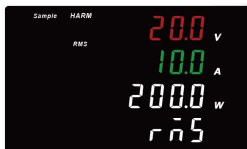
按” THD/%”，选“THD%”模式进入电压电流总谐波相对值测量。按“▲，▼”选择测量各次谐波相对值
