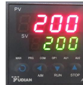
1. 上显示窗 PV，显示温度的测量值。
