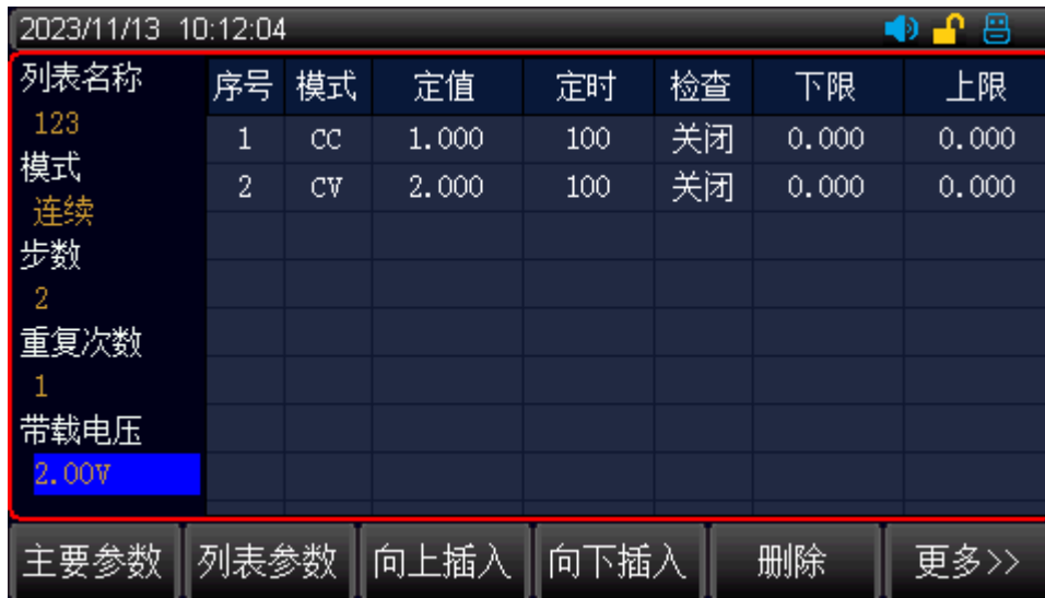
图 7-2-13 自动列表测试设置界面
