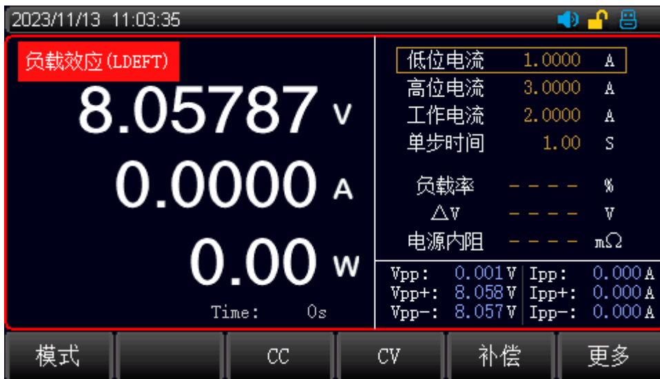
图 7-2-16 负载效应测试界面
