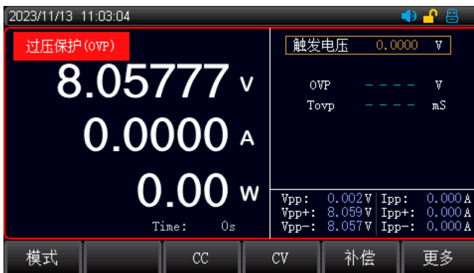
图 7-2-5 OVP 模式测试界面
