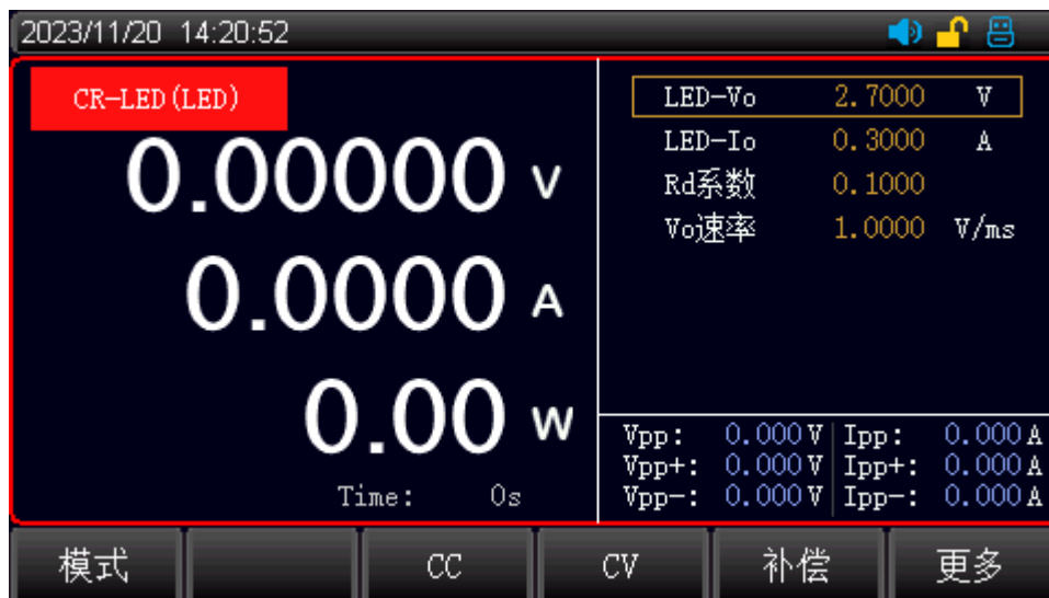
图 7-2-9 CR-LED 模式测试界面
