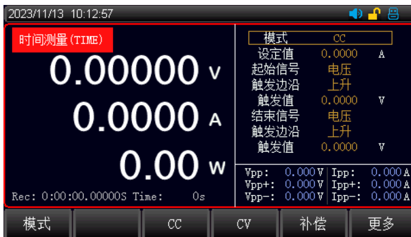
图 7-2-6 时间测量模式界面
