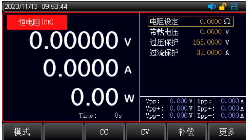
图 7-1-5 恒电阻 CR 设置界面
