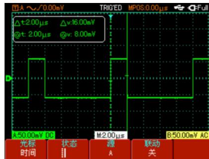
图3-6 光标测量脉冲宽度
