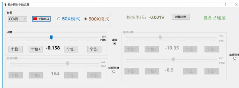
选择对应的 COM 口，点击打开串口，右上角会显示设备已连接，调节栏会显示探头已经保存的参数，反之连接不成功，显示设备已断开，调节栏不会显示参数。
