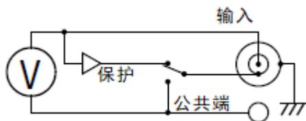
**注：**电压表连接器的内屏蔽层在内部连接到保护层（Guard）或公共端（Common），如图 5-5 所示。必须选择合适的内部连接。要进行受保护的电压测量，必须将其连接到保护层。要进行无保护的电压测量，必须将其连接到公共端（Common）。不正确的设置将导致测量误差。更多信息请参阅“[受保护与无保护的连接](#)”。
