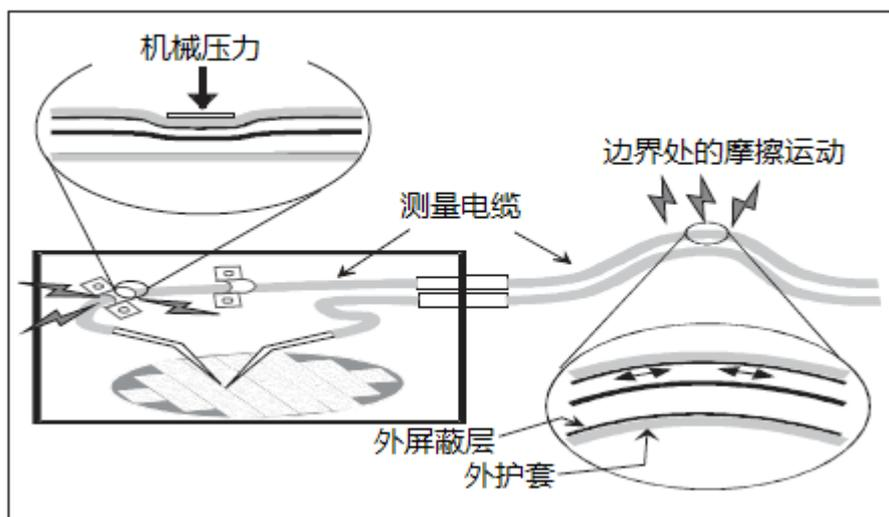
一般地，使用低噪声同轴电缆能减少振动引起的噪声。另外，固定电缆能有效防止振动。注意，给电缆施加过大压力或把它过紧地弯折将会对测量造成不利的影响。
