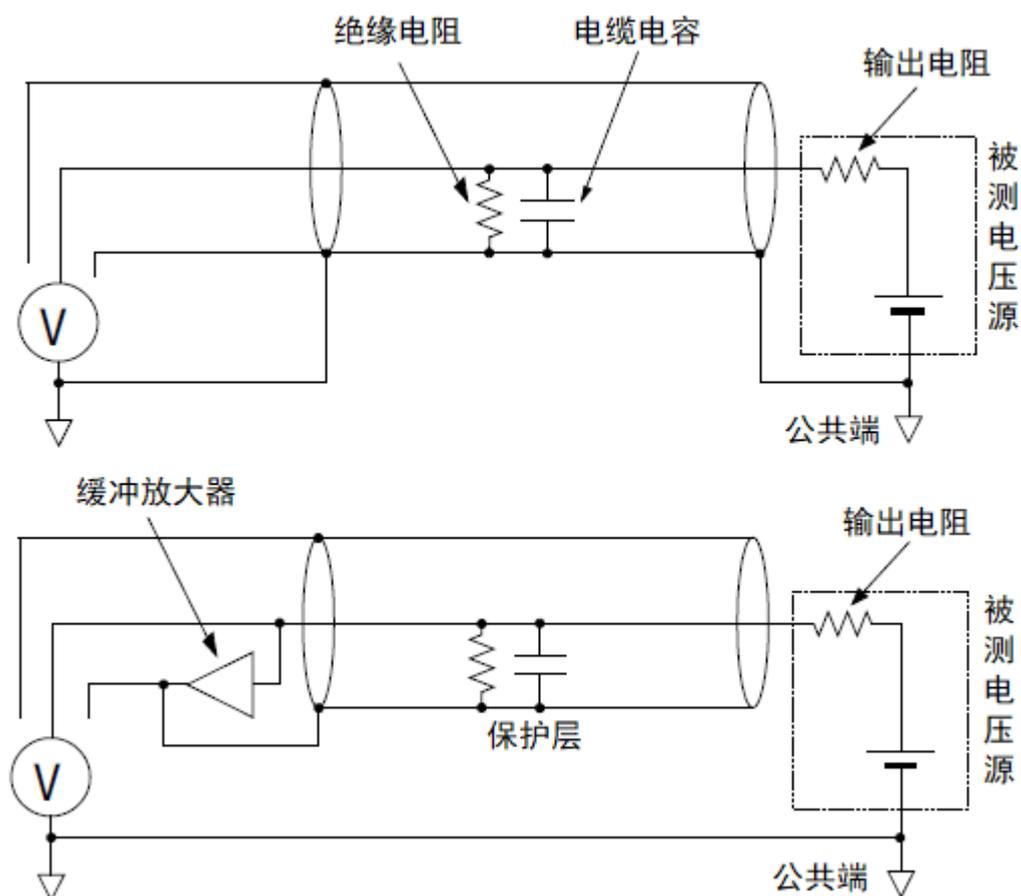
**注意：**请勿将保护端（Guard）连接到任何输出，包括电路公共端、机箱地或任何其他保护端子。否则将损坏仪器。
