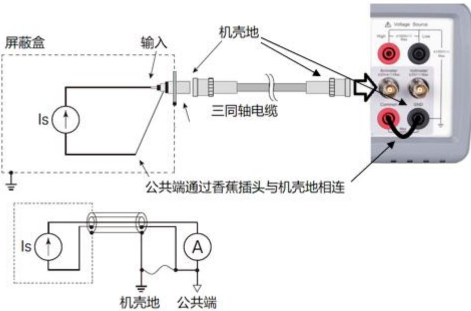
图 5-3 浮地的电流测量连接方式
