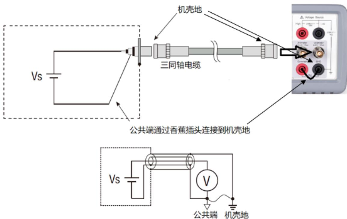
可以使用香蕉头转鳄鱼夹电缆将被测电压的低端连接到公共端（Common），代替连接到电压表的内屏蔽层（Common）。
