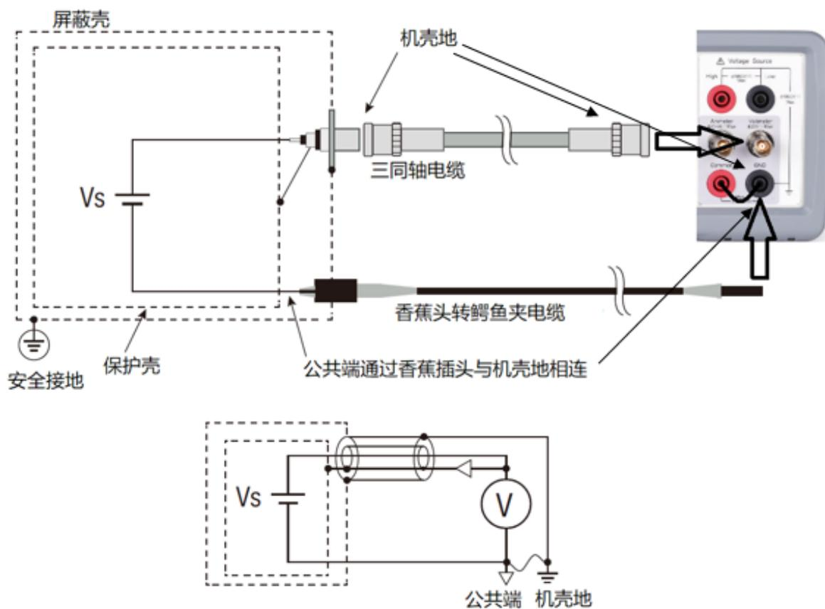
图 5-7 无保护的电压测量连接方式
