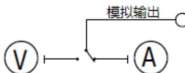
例如，如果测量结果是测量量程的满量程值，则输出电压是 2V；如果结果是满量程的 10%，则输出 0.2V。
