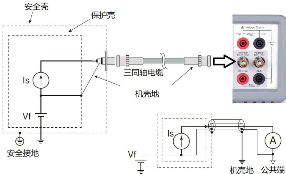
**注：**要实现电流表浮动，请勿在公共端（Common）和机箱地（Ground）之间连接任何电缆。有关详细信息，请参阅“[公共端的连接](#)”。
