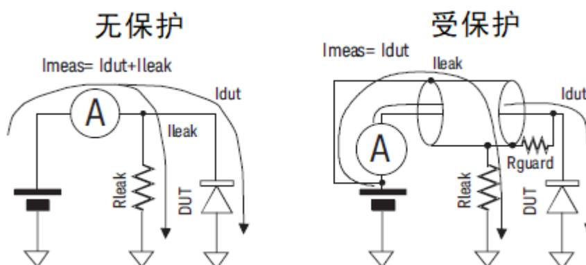
如果电流表输入端和其他电位之间存在电介质，流过的漏电流取决于电势差和电阻。保护技术是在连接电流表输入端的导线上包裹一层与其电位相同导体 (Guard) 以消除电流表输入端与其周围介质之间电势差，这样便可消除漏电流。由于公共端 (Common) 和电流表输入端几乎等电位，将保护层连接到公共端 (Common) 即可。在无保护的情况下 (图 5-4 左)， $I_{leak}$  会造成误差。在受保护的情况下 (图 5-4 右)， $I_{leak}$  不流经电流表，不会影响测量。如果  $R_{guard}$  两端的电势差为 0，则不会有漏电流流过那里。
