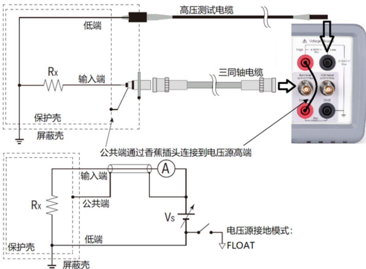
**注：**图 5-11 中所示的连接将电压从电压源施加到公共端（Common）。公共端（Common）可能被施加最高  $\pm 500V$  的电压。
