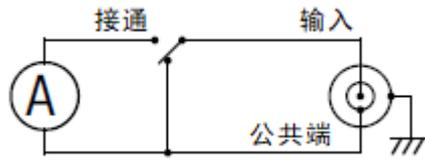
图 5-2 典型的接地的电流测量连接方式
