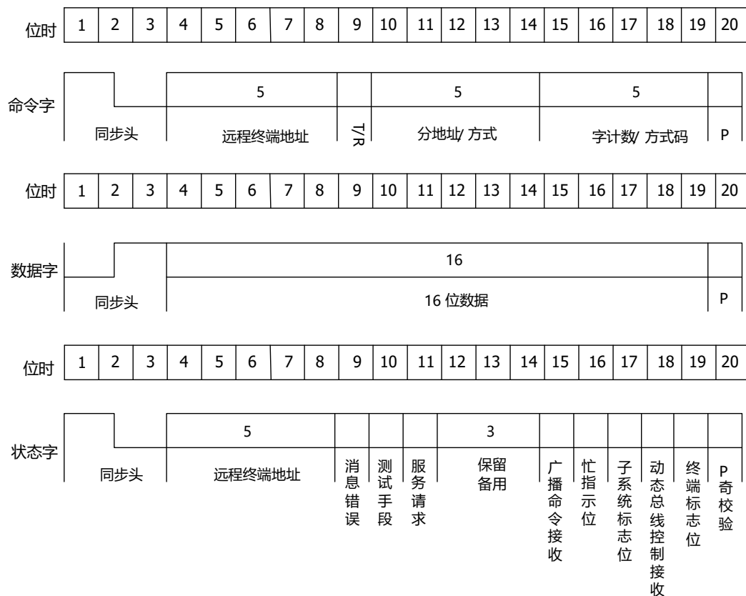
图 8.24 1553B 总线命令字、数据字和状态字格式图
