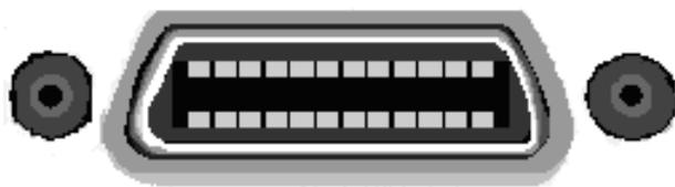
图 5-2 后面板 GPIB 接口
