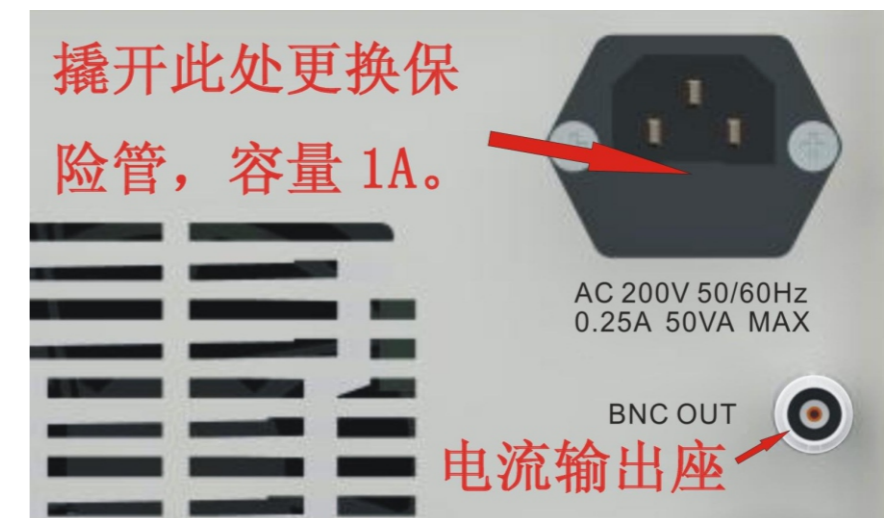
图 4-7 220V 电源输入插座和 BNC 输出座
