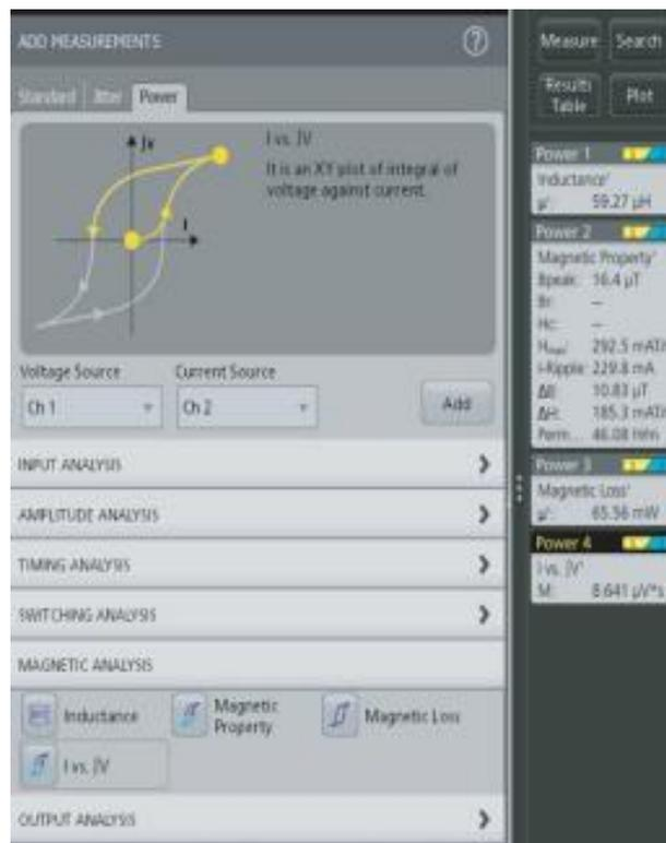
图 3. 指定电压通道和电流通道，设置电感和  $i$  相对于  $\int v$  关系测量
