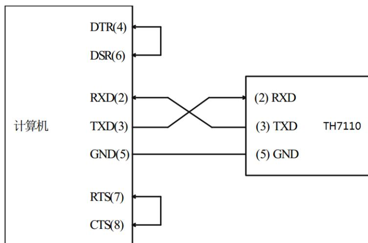
图 6-3 RS-232 内部引脚接线图
