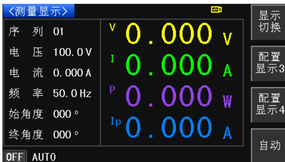
图 3-1 手动模式<测试显示>页面
