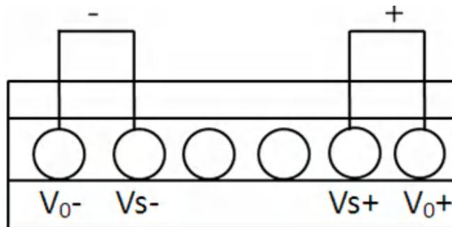
远端量测时待测物的连接示意图和连接方法如下。
