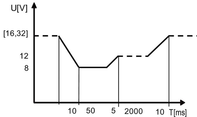
调用可自定义的DIN波形操作 ( 以12.5V电压波形为例 ) :
