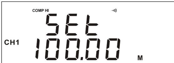
短按左键、右键移动编辑位，短按上键、下键编辑数字或移动小数点，短按OK键保存结果并退出编辑界面，短按ESC键取消并退出编辑界面。当选中最后一位时，再次短按右键可以切换单位；当选中第一位时，再次短按左键可以切换正负号。“COMP HI”或“COMP LO”值的设置范围是：-100M—100M。
