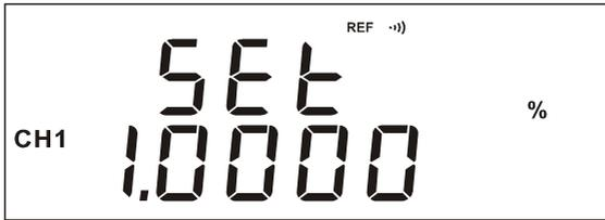
短按左键、右键移动编辑位，短按上键、下键编辑数字或移动小数点，短按OK键保存结果并退出编辑界面，短按ESC键取消并退出编辑界面。当选中最后一位时，再次短按右键可以切换单位；当选中第一位时，再次短按左键可以切换正负号。百分比参考值设置范围：-100M—100M。注：两个通道的设置值相互独立，主通道是CH1时则设置CH1的参数，主通道是CH2时则设置CH2的参数。
