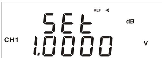
短按左键、右键移动编辑位，短按上键、下键编辑数字或移动小数点，短按OK键保存结果并退出编辑界面，短按ESC键取消并退出编辑界面。当选中最后一位时，再次短按右键可以切换单位。参考电压值设置范围：100mV—1000V。
