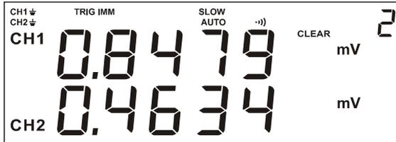
在回读模式下，长按CLEAR键后，LCD的“CLEAR”符号开始闪烁、LCD右上角显示“ALL”，此状态表示询问用户是否删除存储的所有记录。此时，短按OK键删除所有记录、短按ESC键取消删除。如下图所示：
