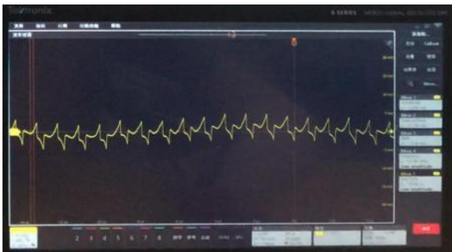
图 4：PWM 模式的纹波
