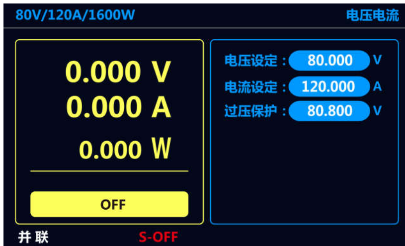
图 5-32 从机发生保护而关闭输出故障
