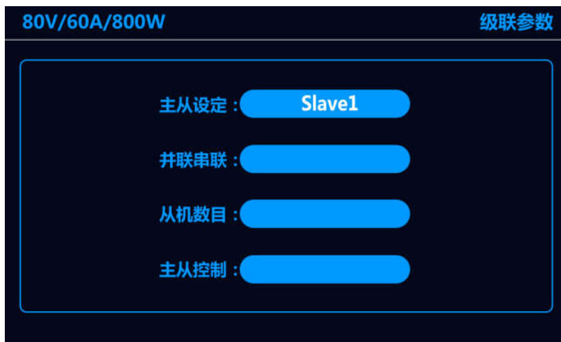
图 5-24 两台同型号并联从机设置界面
