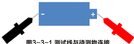
图3-3-1 测试线与待测物连接
