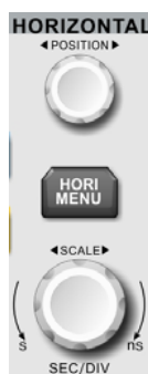
图 1-7 面板上的水平控制区
