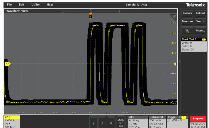
基于金标准参考信号的极限模板测试
