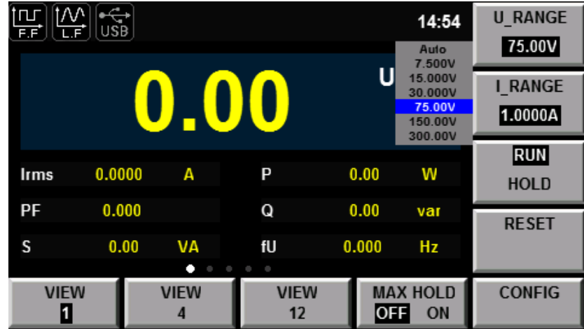
图-电压量程图（下图以 IT9121 机型为例）
