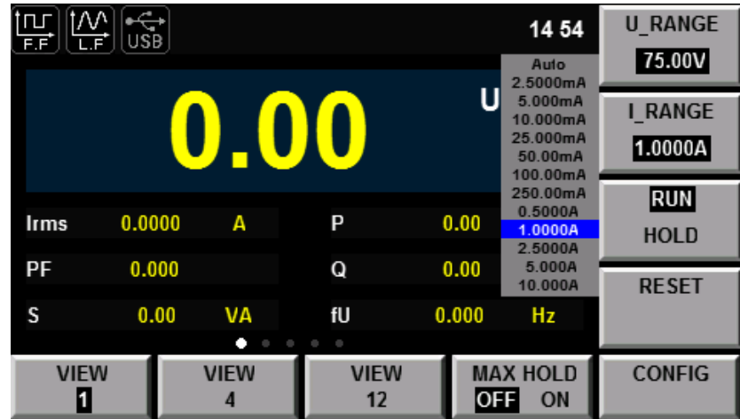
图-电流量程图（下图以 IT9121 机型为例）
