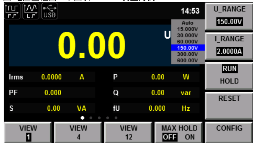
图-电压量程图（下图以 IT9121 机型为例）
