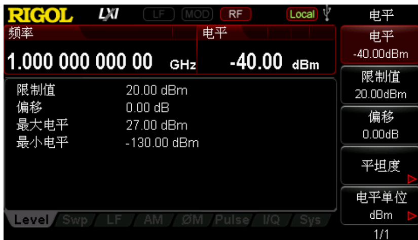
图 4-1 输出 RF 信号参数设置界面
