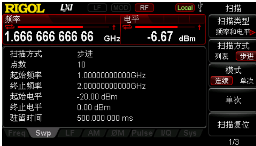
图 4-2 输出 RF 扫描信号参数设置界面
