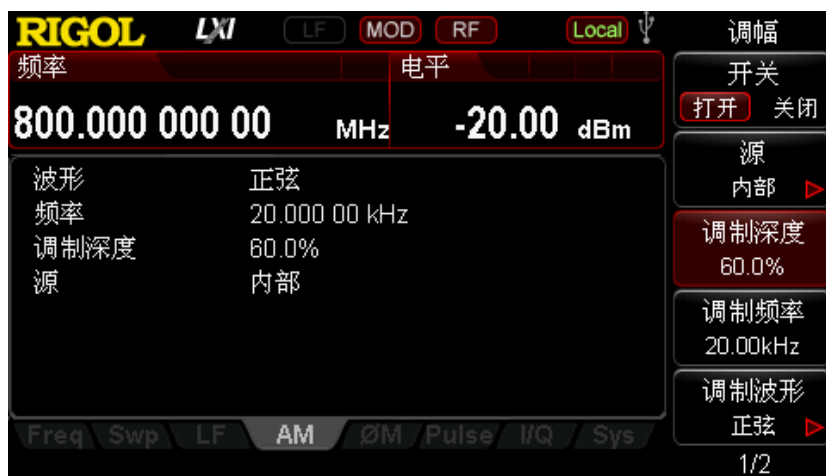
图 4-3 输出 RF 已调信号参数设置界面
