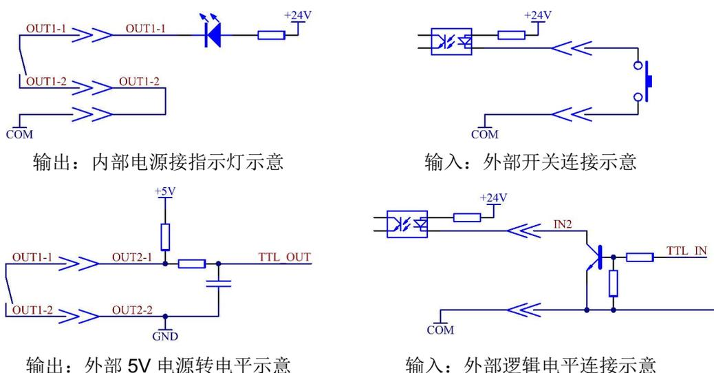
图 4.4.2: 外部电路连接示意图
