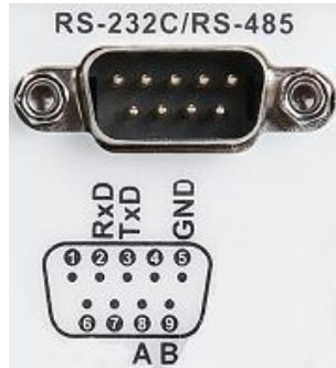
图 0-1 RS-232C 连接器，D-sub 9 针公头
