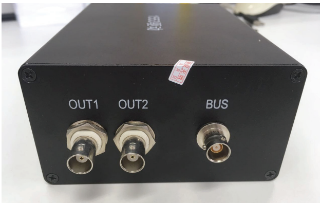
信号隔离适配器的输出端口, BUS 口为三同轴接口, 可以直接输出差分信号, OUT1/OUT2 可以与示波器连接进行信号观测
