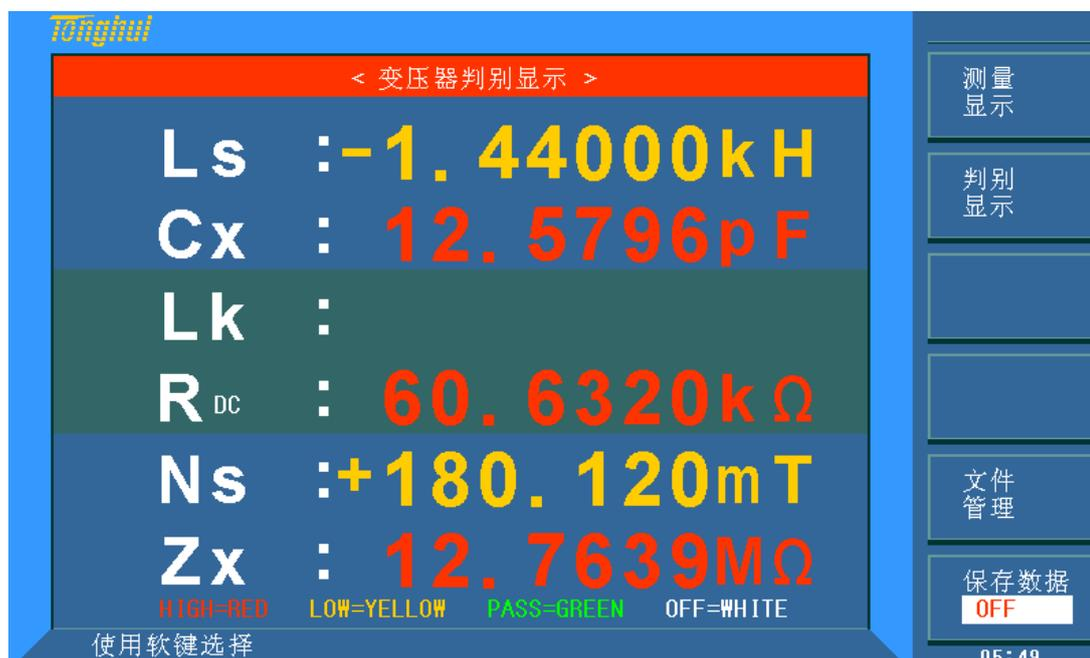
此页面的各行显示了变压器各参数的显示结果，并通过字符颜色显示判别结果。如果判别结果为红色字符表示H上超，黄色字符表示L下超，绿色字符显示表示合格，白色字符显示表示不分选。
