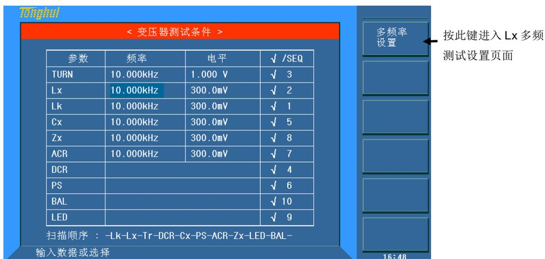
在 Lx 多频测试设置画面下进行所需的针对不同脚位不同频率设置如下图：
