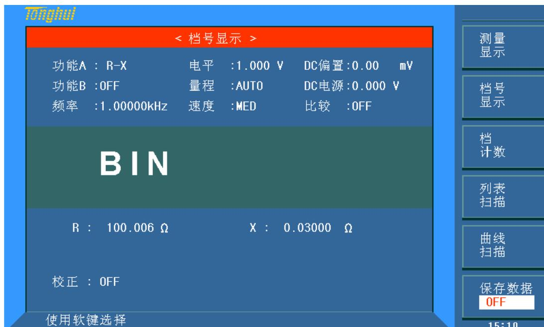
下列测量控制参数可在<档号显示>页面设定。
