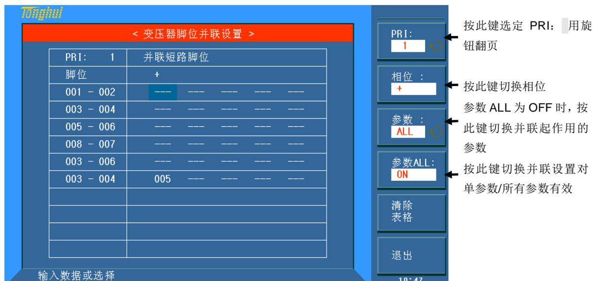
以上为：并联示例变压器 Ns1，Ns2 测试时短路到“+”端的脚位设置
