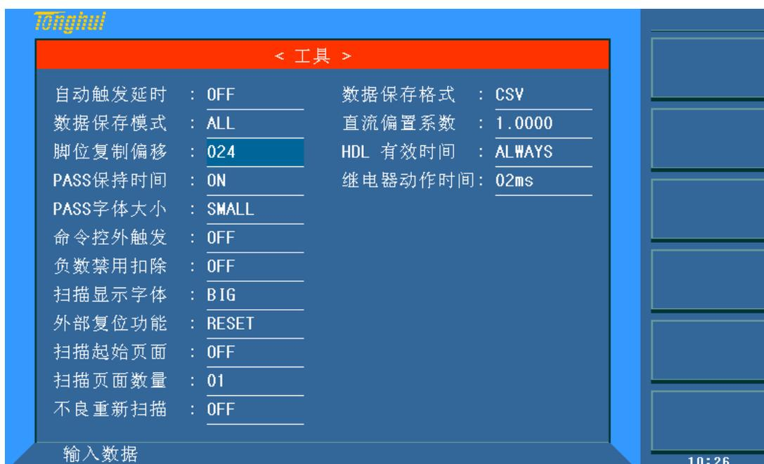
该功能主要用来变压器参数复制(复制 A=>ALL)时，自动复制脚位。
