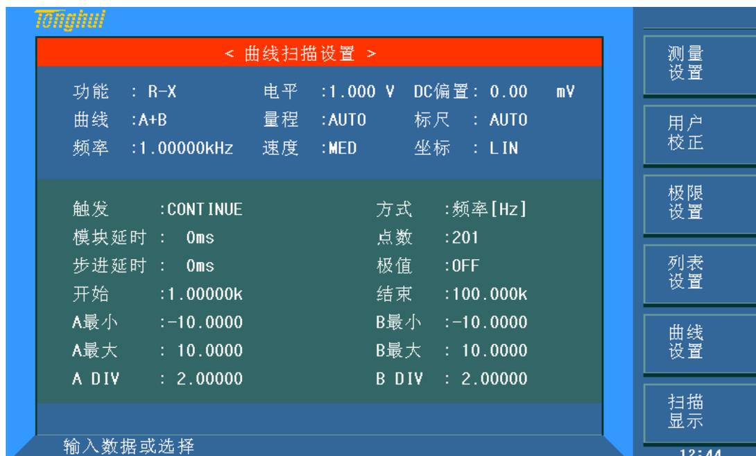
这一显示功能页面用于完成对曲线扫描测量参数的设定，包括功能，方式，开始、结束，主副参数纵坐标的上下限等。
