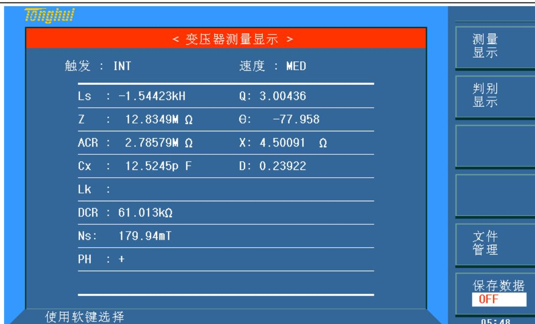
此页面的各行显示了变压器的各参数显示结果。
