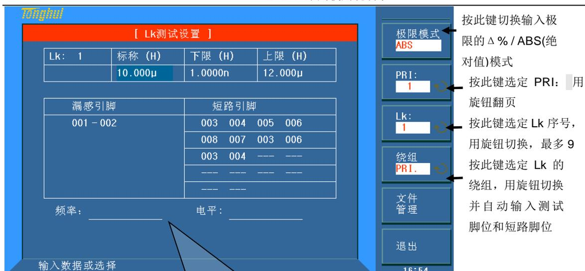
在这里输入需多频测的频率, 后面为多电压, 如果此区域为空白, 则测量时自动使用<变压器测试条件>页面中设置的频率和电压。
