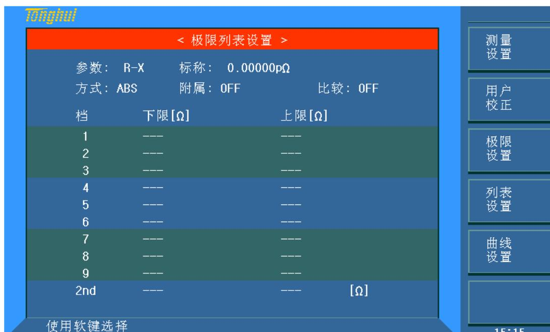
在该页面可以对仪器比较器功能进行设置。TH2829X 可设定 9 个主参数的档极限以及一个副参数的档极限值。被测结果可分选成最多 10 个档（BIN1 至 BIN9 和 BIN OUT）。如果被测件的主参数在 BIN1 至 BIN9 的极限范围内，但是其副参数不在极限范围内，这时被测件被分选到附属档中。当 TH2829X 安装了 HANDLER 接口，并运用在自动测试分选系统时，比较功能特别有用。下列比较功能的极限参数只能在<极限列表设置>页面进行设定。
