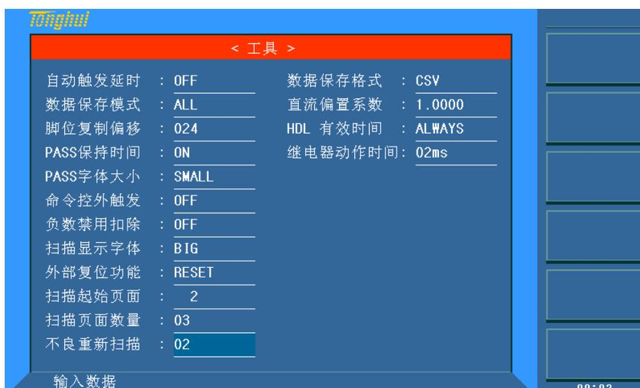
**注：**不良重新扫描的时间间隔可在<变压器编号>中的“扫描触发延时”里设置。
