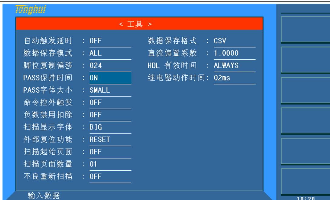
该功能是指扫描完成后，PASS 保持显示的时间长短，如果测试结果为 FAIL，则一直保持。该功能与变压器自动扫描间隔独立，如 PASS 保持时间设置为 3 秒，变压器自动扫描间隔设置为 4 秒，则 PASS 状态保持 3 秒，再过 1 秒后，下次测试开始。如 PASS 保持时间设置为 3 秒，变压器自动扫描间隔设置为 2 秒，则 2 秒后开始下次测试。
