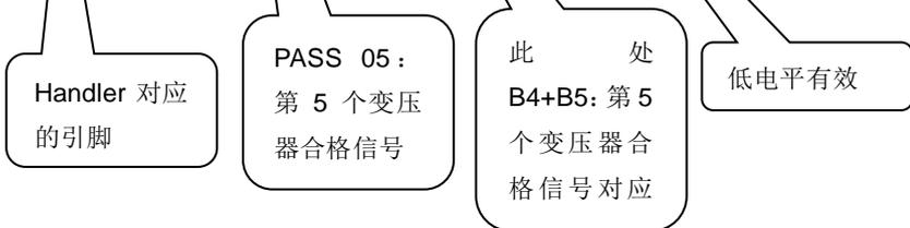
**注意：** **LxLk:** Lx 合格为 1 脚输出，不良为 2 脚输出；Lk 合格为 3 脚输出，不良为 4 脚输出。**GD1/GD2:** 仅测试 2 页数据，当此 2 页数据中有 1 页合格，输出合格信号 25 脚，否则输出不良信号 24 脚。当使用 HFLX 双气缸扫描盒时请使用 **DEFAULT** 才能正常工作。
