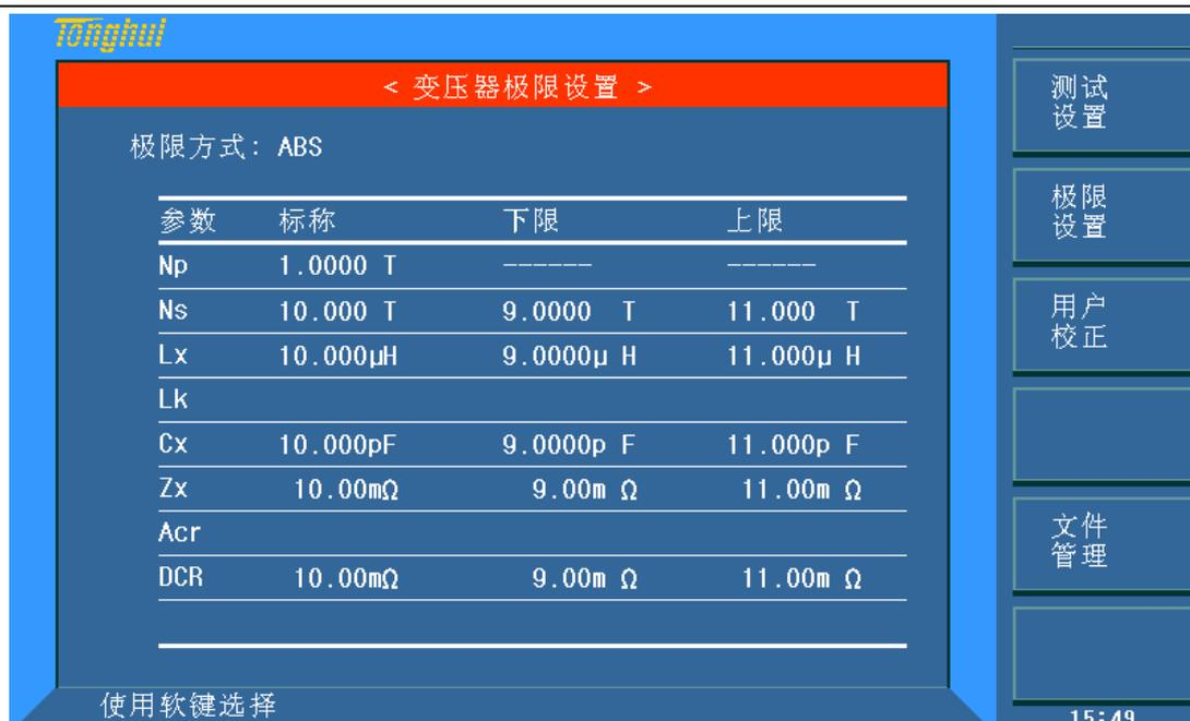
这一显示功能页面用于设定变压器测量参数，匝比，主级电感，次级电感，主级的直流电阻，用于判别显示的标称值，上下极限值，和上下限的模式。
