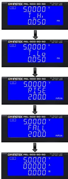
设定 level High 时间，中间的 5 位显示器显示「T-Hi」，下方的 5 位显示器显示设置值，单位为 ms，T-Hi 设定范围从 0.050ms 到 9999ms，每设定旋钮及按键调整间隔为 0.001ms。
