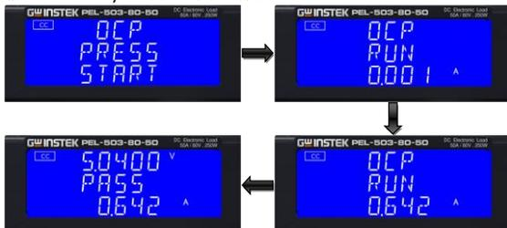
9. UUT 的输出电压降低于阈值电压 (V-th 设置), 且 OCP 触发点在 I<sub>Hi</sub> 和 I<sub>Lo</sub> 限制之间, 则中间的 5 位 LCD 显示屏将显示“PASS”, 否则显示“FAIL”。
