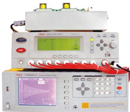
TH9201S+TH2882A+TH90010 测试方案 (交直流耐压+绝缘电阻+匝间绝缘扫描测试方案)
