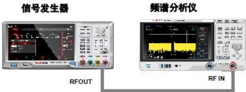
图 3-10: 获取单一信号的仪器设置
