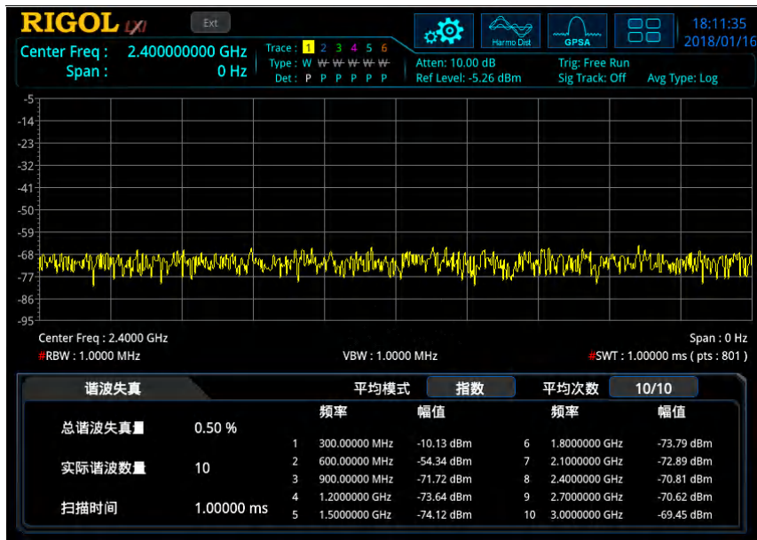
图 2-11 谐波失真测量界面
