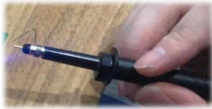
图 9：探头的探针和接地弹簧
