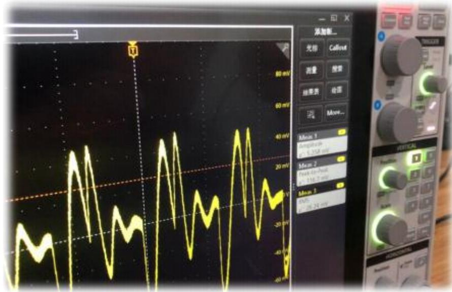
图 5：示波器自动测量功能
