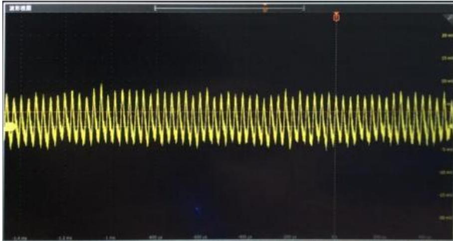
图 7: 探头衰减设为 10X 的波形
