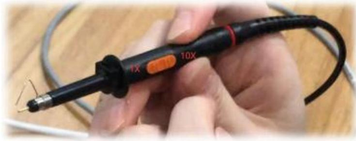
图 6: 示波器电压探头衰减设置开关
