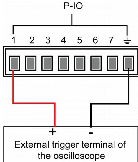
2. 确认引脚1的功能设置为默认的选项，即 **IO-1. Ps-Fault-Clear, Not-Invert**。
