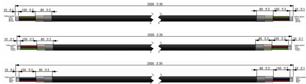
其中，黄绿色线为接地线，接入仪器后面板电源输入的PE端子，其余为火线，对应接入仪器后面板电源输入的L1、L2、L3端子。
