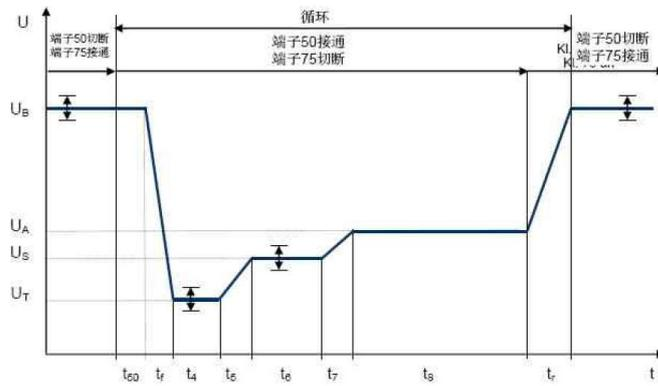
E-12 具有智能发电机调节装置的电压波动波形
