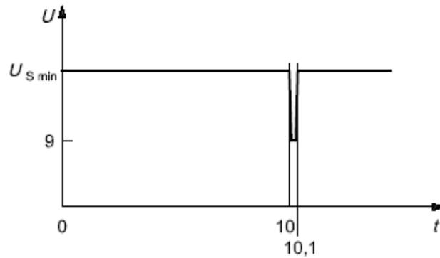
调用测试操作步骤如下（以12V电压波形为例）。
