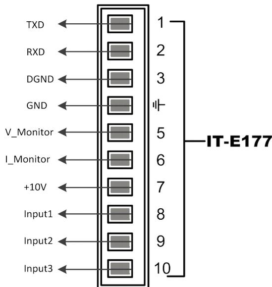
使用RS-232接口通讯时，需将IT-E177的引脚1、引脚2、引脚3与PC进行连接。引脚说明如下：
