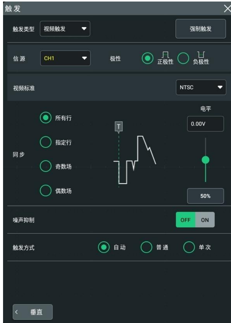
图 8.8 视频触发配置菜单
