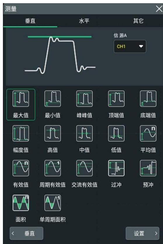
图 10.4 垂直测量参数
