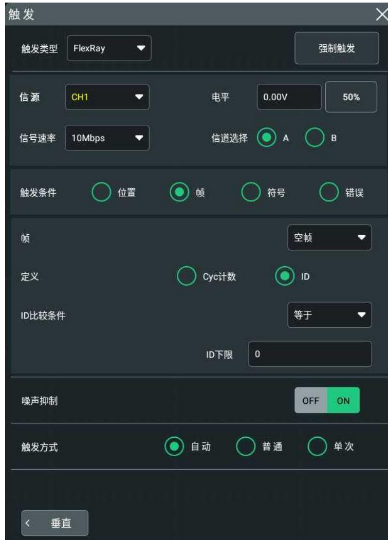
图 8.36 FlexRay 触发配置菜单
