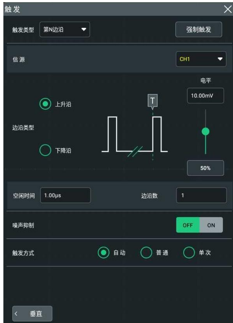
图 8.23 第 N 边沿触发配置菜单
