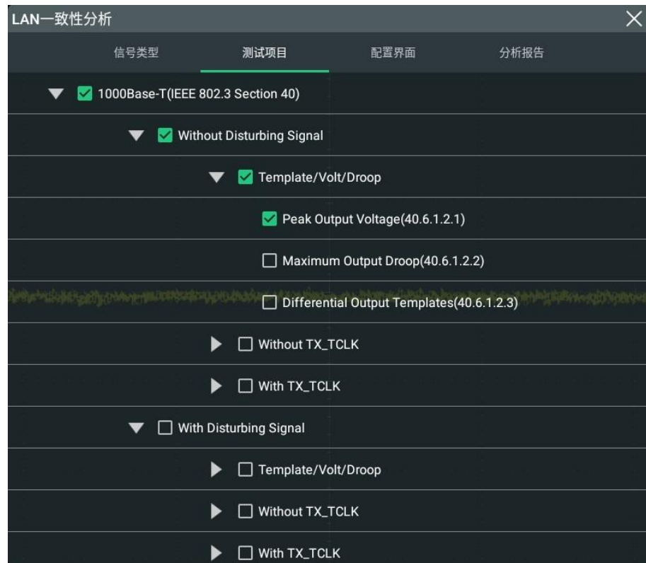
图 18.5 1000Base-T 信号测试项目
