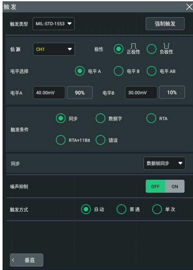
图 8.43 MIL-STD-1553 触发配置菜单
