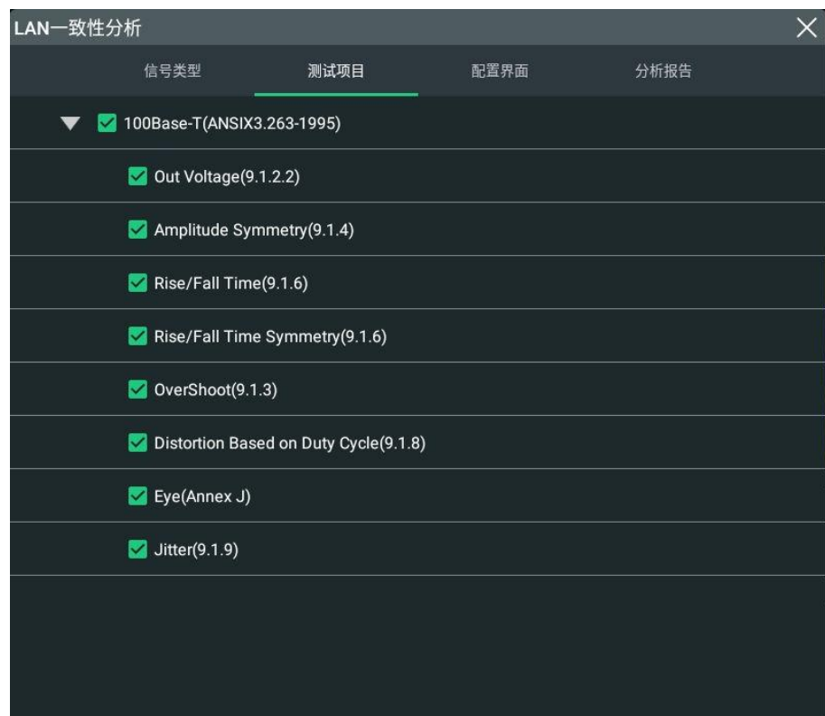
图 18.4 100Base-T 信号测试项目
