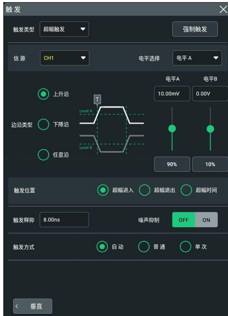
图 8.17 超幅触发配置菜单
