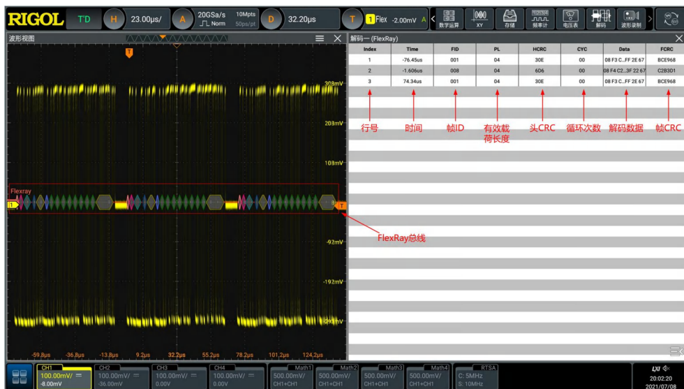
图 17.21 FlexRay 解码事件表
