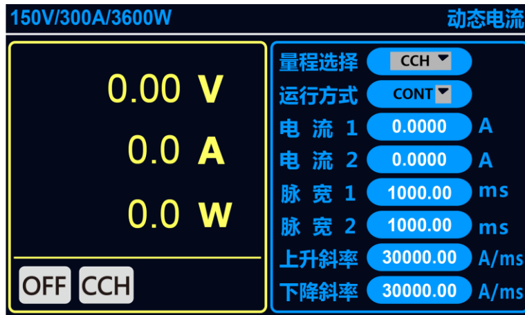
图 6-5 动态电流工作界面
