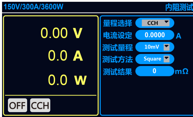
图 6-18 内阻测试工作界面
