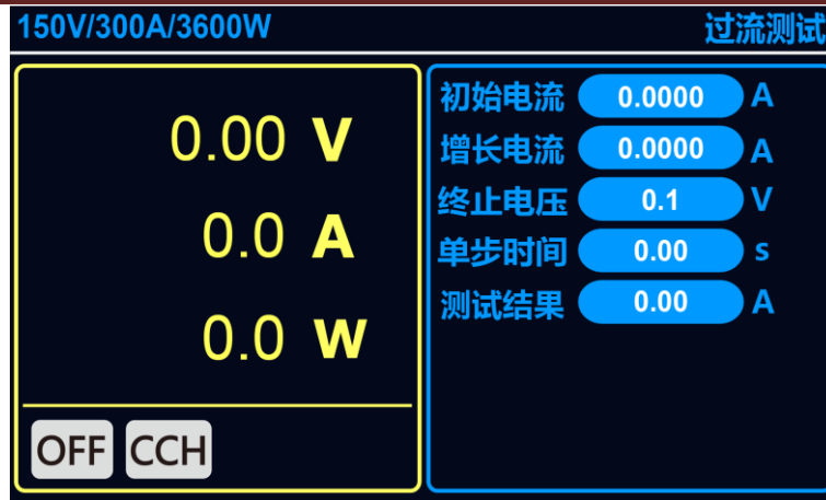
图 6-19 OCP 过流测试工作界面
