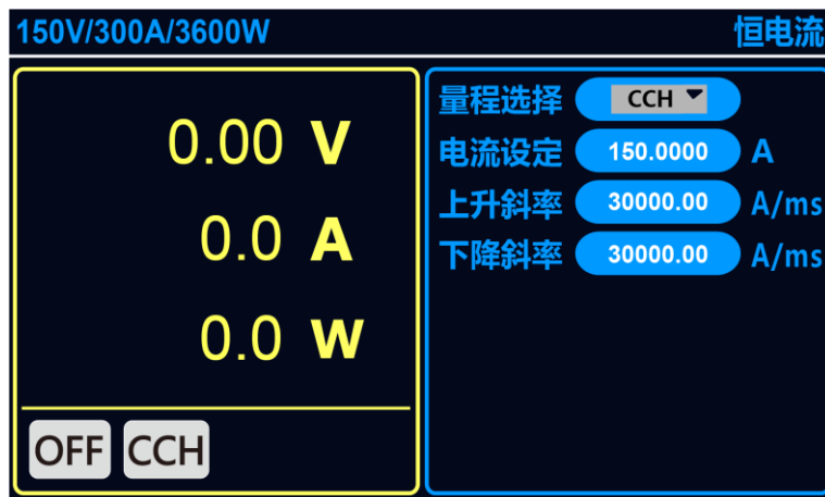
图 6-1 恒电流工作界面
