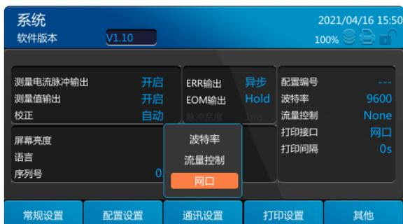
通过左右按键选中各个输入框后，直接输入数字键就可以进行编辑。
