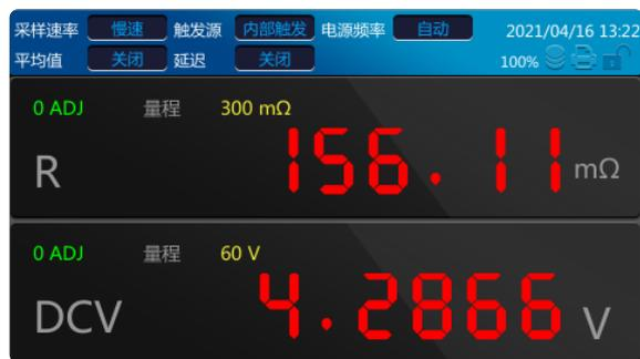
Ω测量类型（电阻测量）
