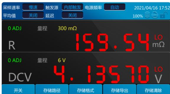
所有的存储选项设置好以后再选择开启，存储设置才会生效。存储功能开启时，不能修改存储设置。
