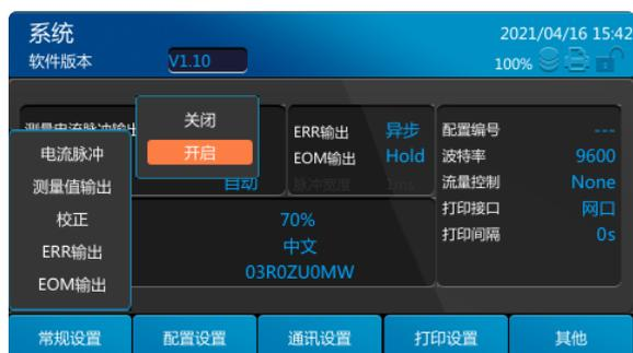
使用上下方向键选择[关闭]和[开启]，最后点击[Enter]键完成设置。如果想取消设置，点击[Esc]。
