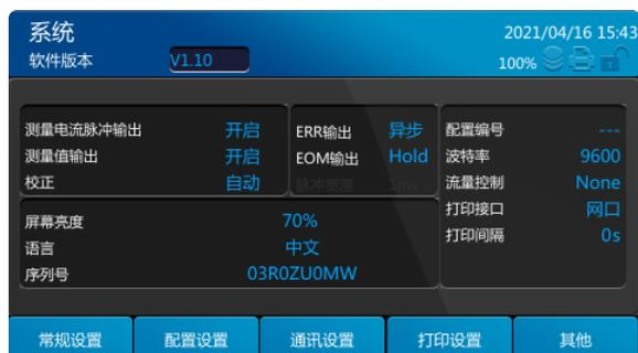
测量值输出的开关、自动/手动校正设置、ERR输出异步/同步、EOM输出方式等依照该操作方式进行操作。
