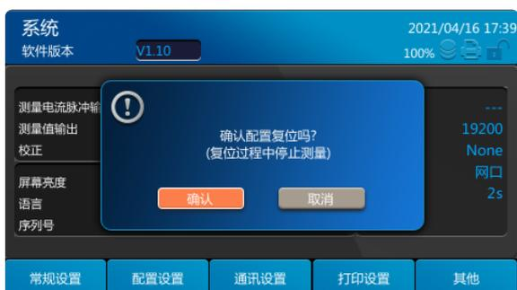
选中[系统复位]弹出如下对话框。系统复位需要清除本地内存、配置、统计。系统复位也对面板保存数据进行初始化：
