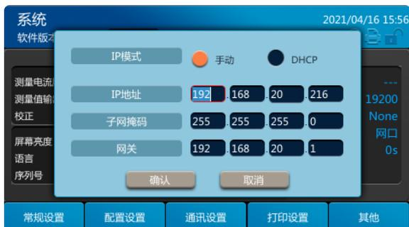
完成设置后，按上下方向键选中[确认]设置，或选中[取消]设置，点击[Enter]键完成设置。
