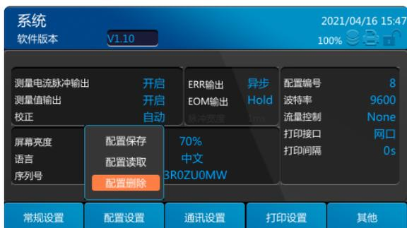
选择[配置删除]弹出配置编号输入框，填入需要删除的配置编号，点击[Enter]键，
