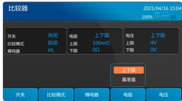
在[上限]中输入[0.2]，点击上下键调节到下限输入框，输入[0.05]。按[Enter]键完成设置。
