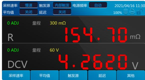
再点击[F1]选中[采样速率]的设置，每按一次F1键切换一次。直到需要的采样速率被点亮。
