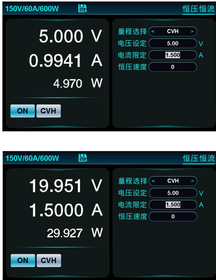
图 5-13 恒压恒流拉载
