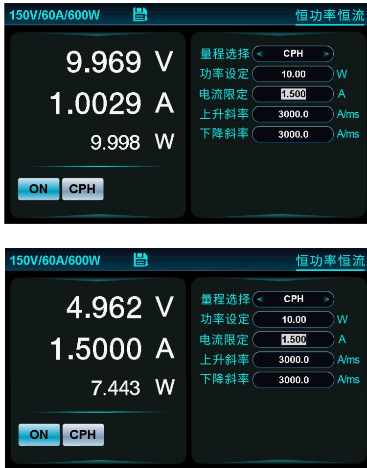
图 5-17 恒功率恒流拉载
