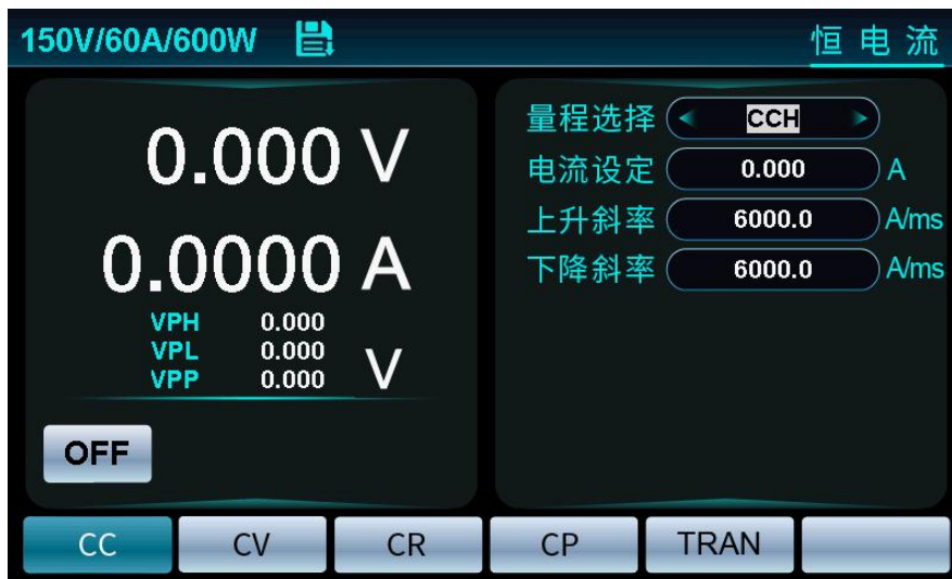
图 5-52 恒电流电压纹波
