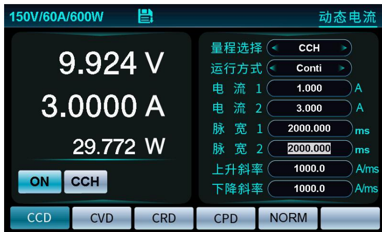
图 5-31 动态电流拉载
