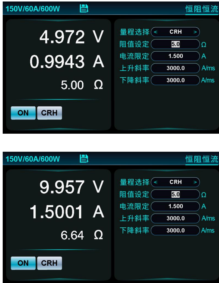
图 5-15 恒阻恒流拉载
