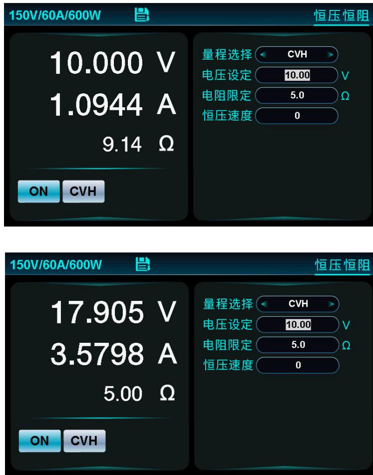
图 5-19 恒压恒阻拉载
