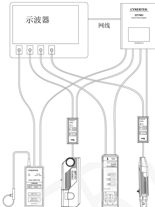
上述示意图表示了智能探头控制器、智能探头、示波器的正确连接方法：
