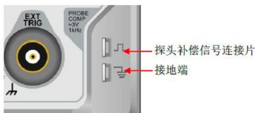
图 4-1 探头补偿信号连接片和接地端
