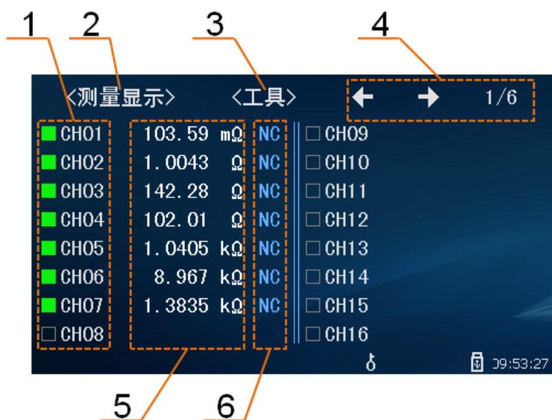
图 2-4 Scan 模式下扫描显示区域
