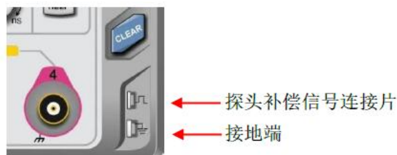
图 4-1 探头补偿信号连接片和接地端
