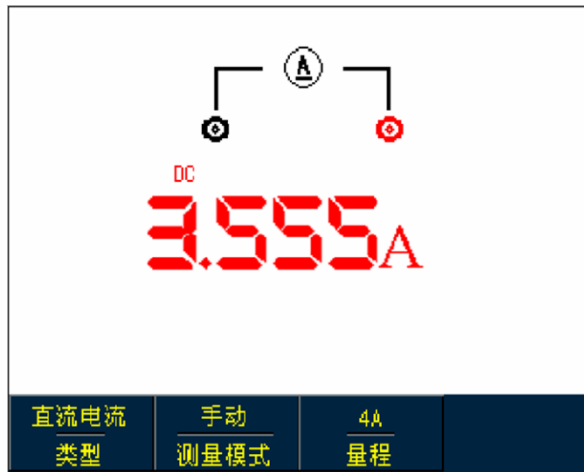
图5-16 大于400mA直流电流测量
