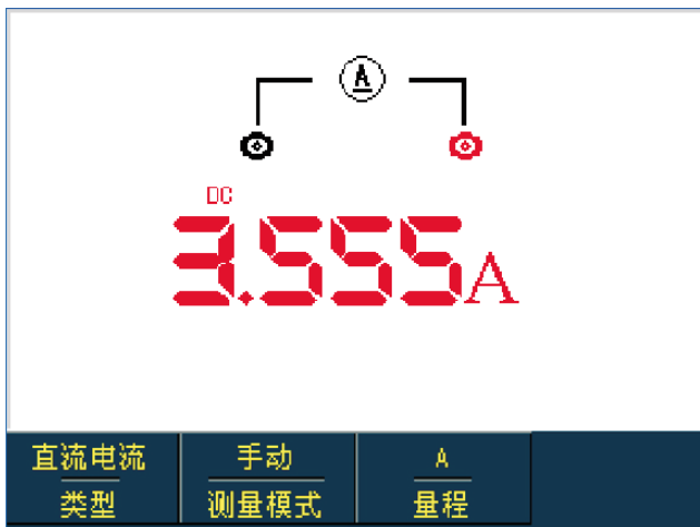
图5-9 大于400mA直流电流测量
