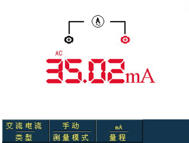
图 5-11 小于 400mA 交流电流测量
