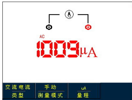
图5-17 小于等于1mA交流电流测量
