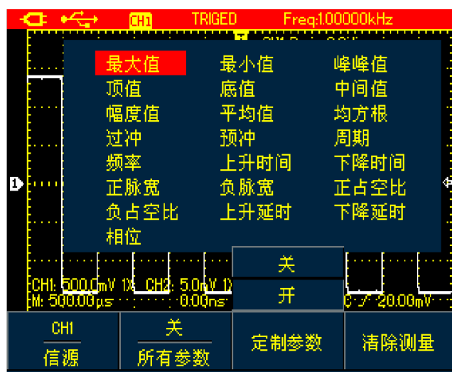
图4-17 UTD1000L定制参数测量
