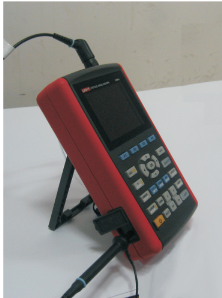
图3-2 本机补偿信号连接
