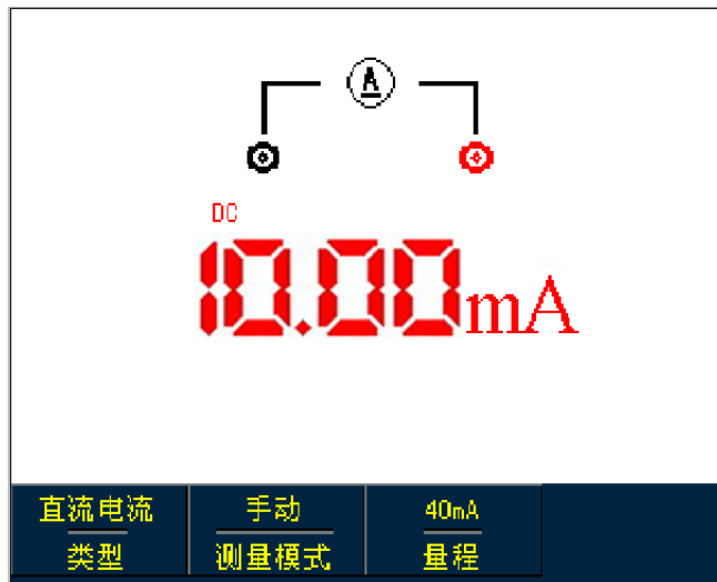
图5-14 小于40mA直流电流测量
