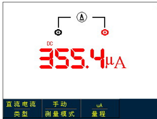
图 5-7 小于 4mA 直流电流测量
