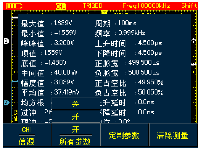
图6-16 UTD1000L全部参数测量
