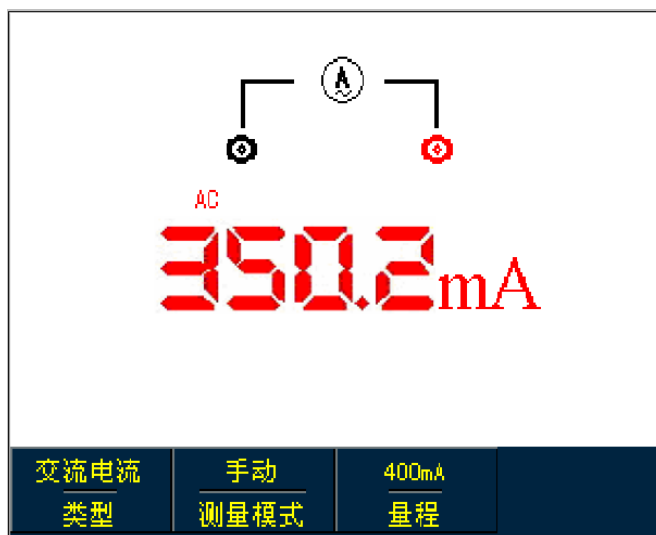
图5-19 测量40mA-400mA的交流流电流
