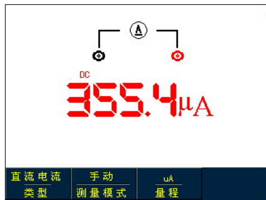
图5-13 小于等于1mA直流电流测量
