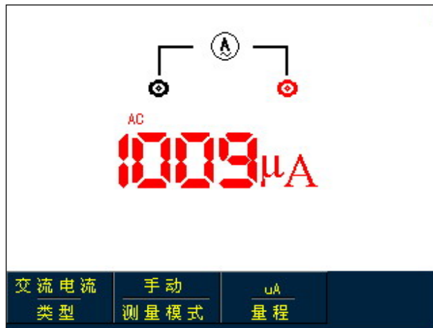
图 5-10 小于 4mA 交流电流测量
