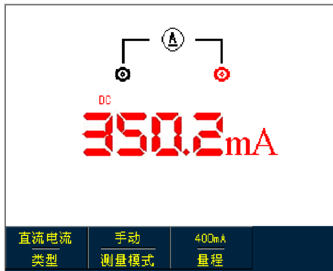
图5-15 测量40mA-400mA的直流电流
