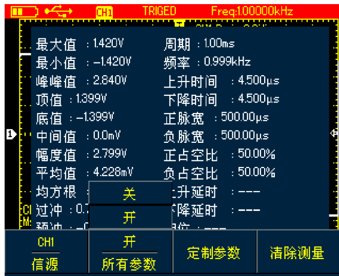
图4-16 UTD1000L全部参数测量
