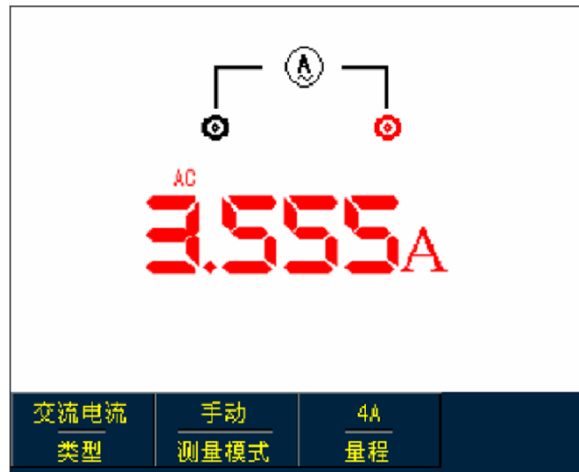
图5-20大于400mA交流电流测量
