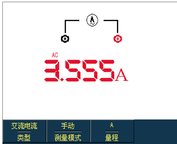
图 5-12 大于 400mA 交流电流测量
