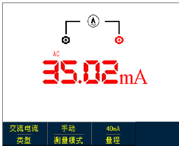
图5-18 小于40mA交流电流测量
