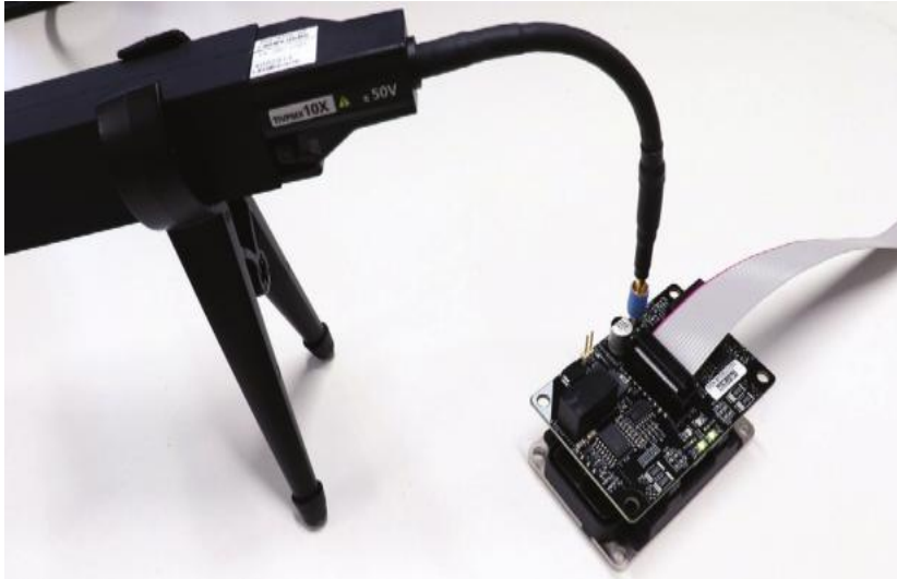
图 15. 方针式传感器尖端电缆。图片由 Wolf speed 提供，获准重新印刷
