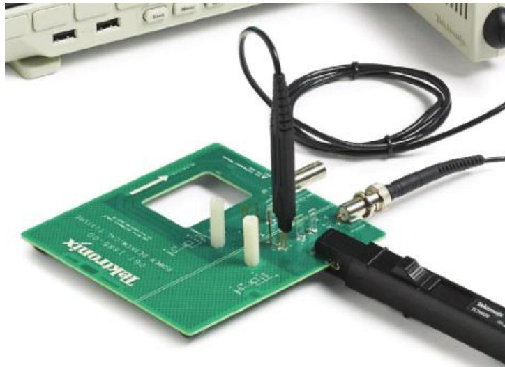
图 11. 功率测量时延校正和校准夹具 (067-1686-00)。这些连接提供了一种方便的方式，可以补偿电压探头和电流探头之间的定时差
