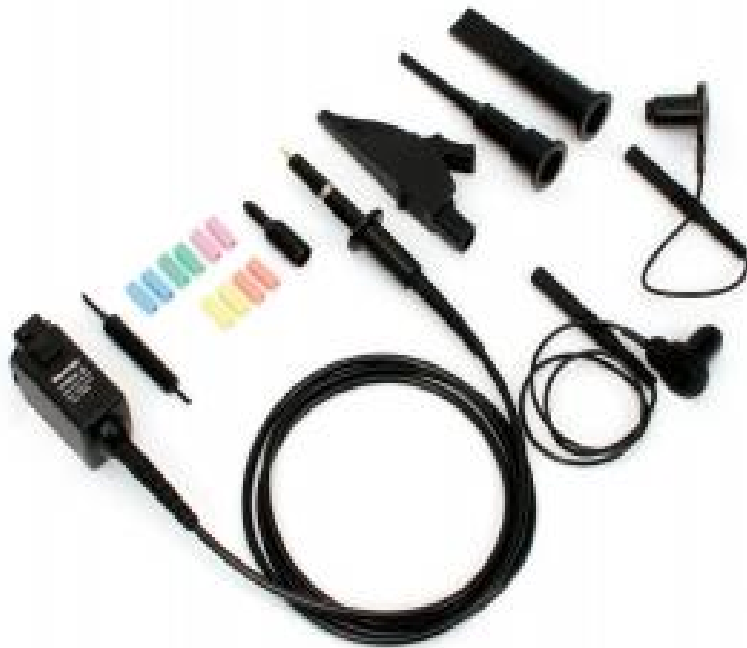
图 5. 泰克 TPP0850 电压探头：单端，参考地电平探头，支持 50x 衰减（高达 100VRMS）及 800 MHz 带宽
