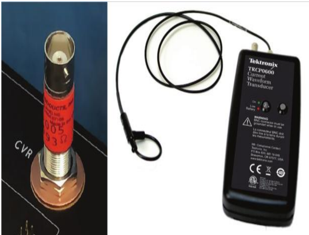
图 7. 探头实例：(a) 电流查看电阻器 (T & M Research SSDN-005, 400 MHz)。图片由 Wolfsped 提供，获准重新印刷。(b) Rogowski
