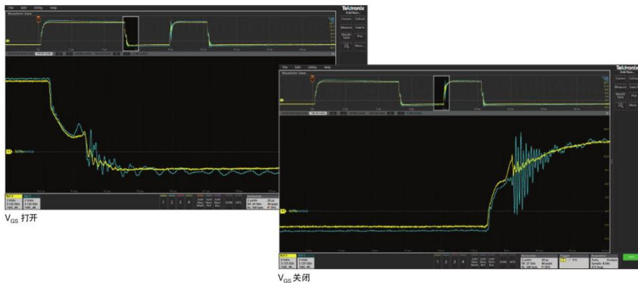
图 4. 差分探头 (蓝色轨迹) 与 IsoVu 光隔离探头 (黄色轨迹) 对比
