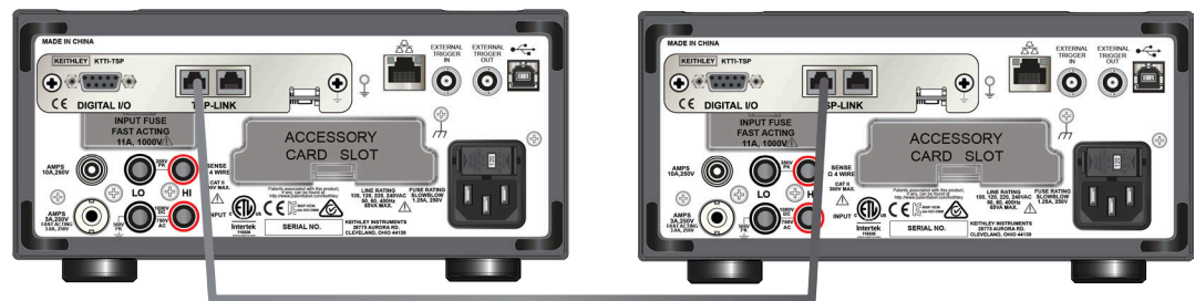
图 42：两个通过 TSP-Link 连接的 DMM
