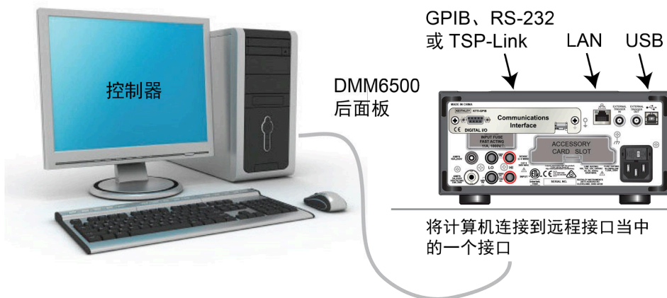
图 15: DMM6500 远程接口连接
