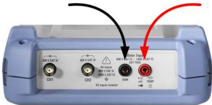
图 4-1: 连接测试引线到万用表输入端
