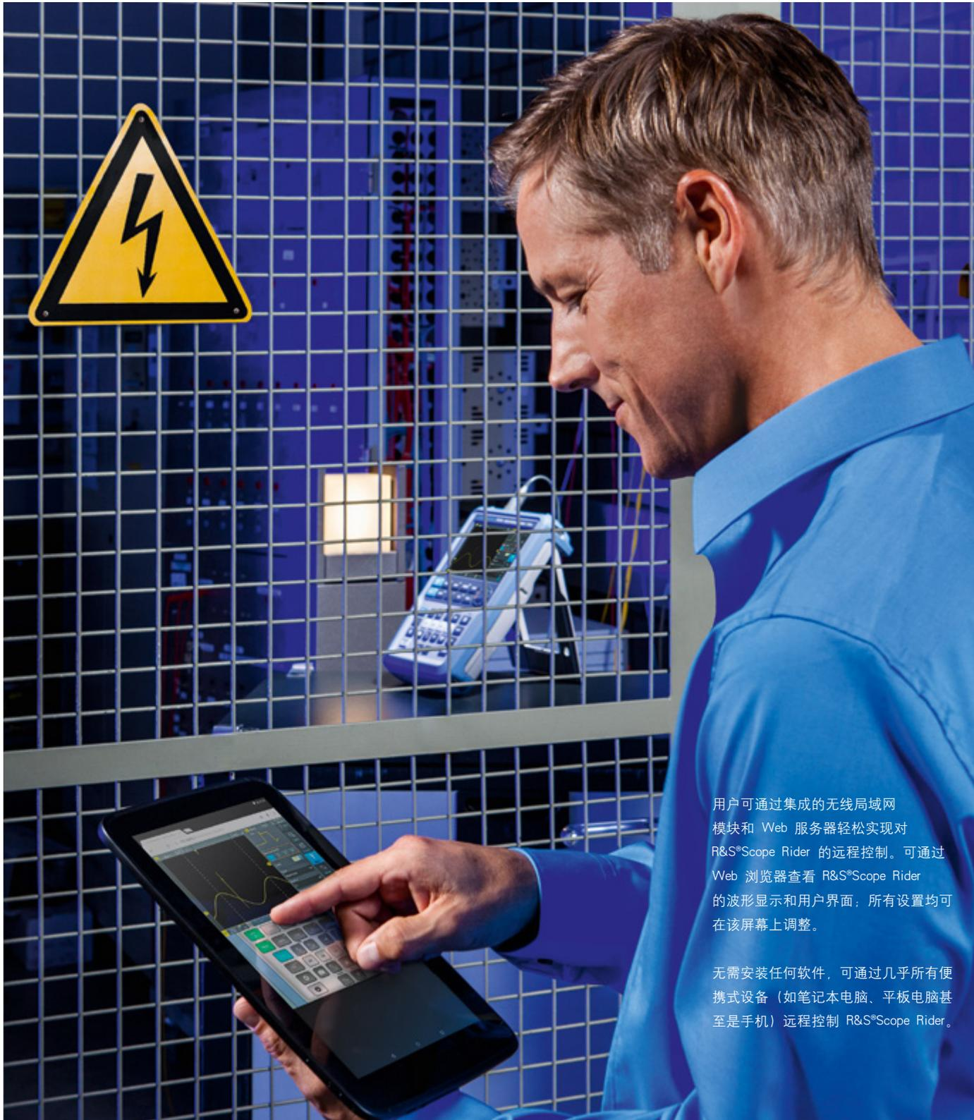
用户可通过集成的无线局域网模块和 Web 服务器轻松实现对 R&S®Scope Rider 的远程控制。可通过 Web 浏览器查看 R&S®Scope Rider 的波形显示和用户界面；所有设置均可在该屏幕上调整。
